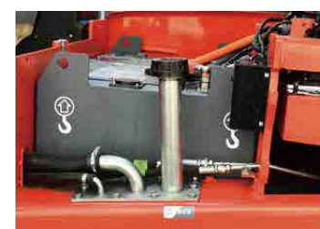
Der Hydrauliköltank befindet sich auf der linken Seite und lässt sich leicht befüllen und kontrollieren.
